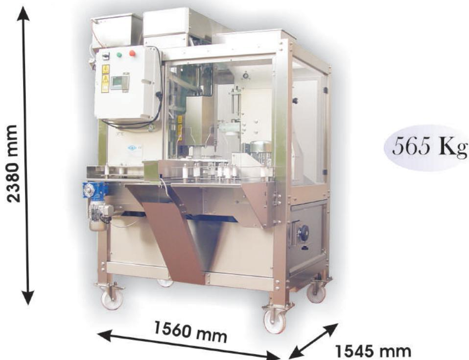
Il monoblocco Mbl 100 è realizzato in acciaio inossidabile AISI 304, ed è costituito da una stazione di riempimento e da una stazione di tappatura con distributore automatico.
